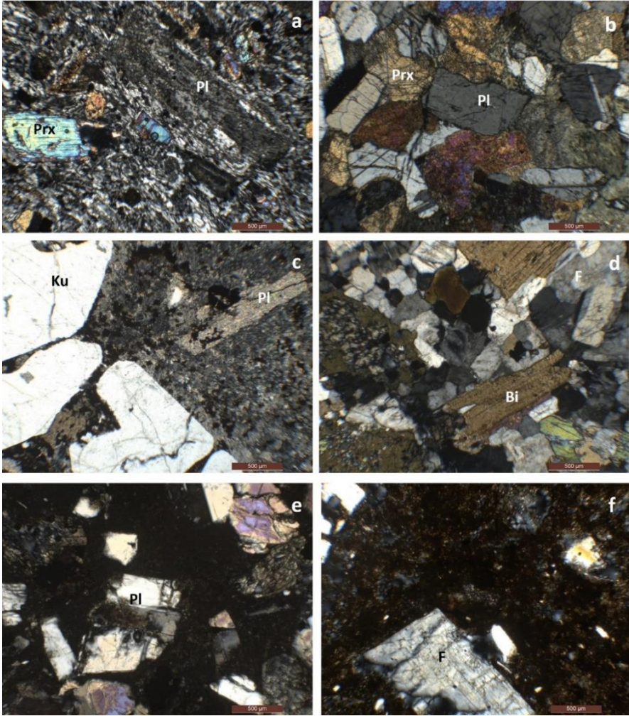
Şekil 10: Yapılarda sıklıkla kullanılmış olan magmatik kayaç örneklerinin polarizan mikroskop altındaki çift nikol görüntüleri (Ku: Kuvars, Pl: Plajiyoklaz, Bi: Biyotit, Prx: Piroksen)
