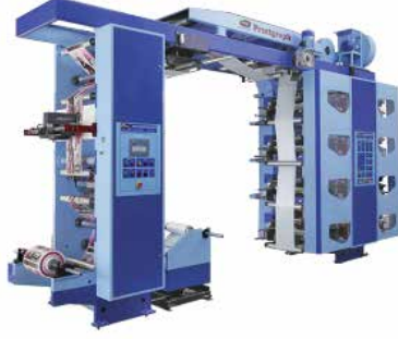
Şekil 6: Toplu Düzen Flekso Baskı Makinesi. [11]
