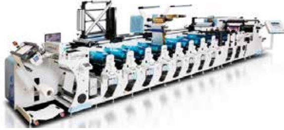
Şekil 7: Sıralı Düzen Flekso Baskı Makinesi. [12]
