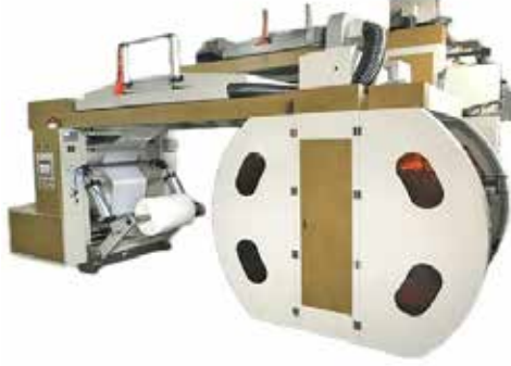
Şekil 8: Merkezi Baskı Silindirli Flekso Baskı Makinesi. [13]
