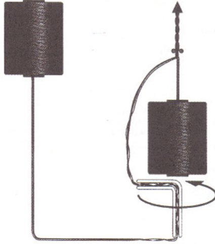
řekil 14. Kablolama iřleminin temel prensibi [2]
