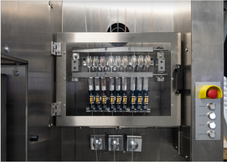
Şekil 6. Spin-finish uygulama bölgesi [7]
