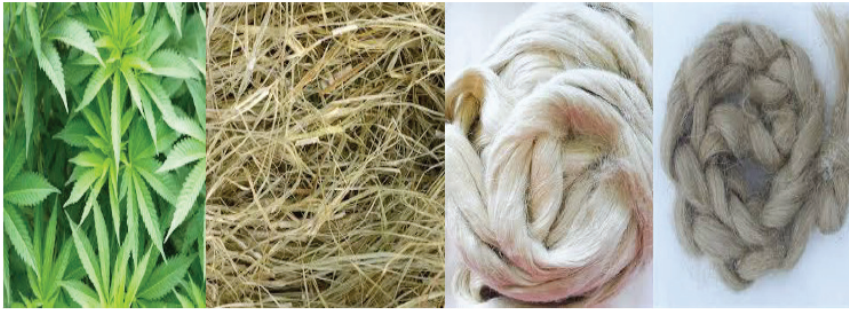
Şekil 2. Kenevir lifinin dönüşüm aşamaları [21]
