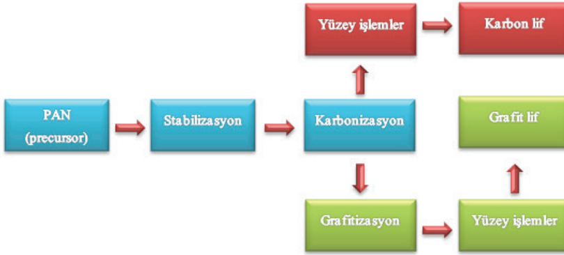
Şekil 2. Karbon lif üretim aşamaları
