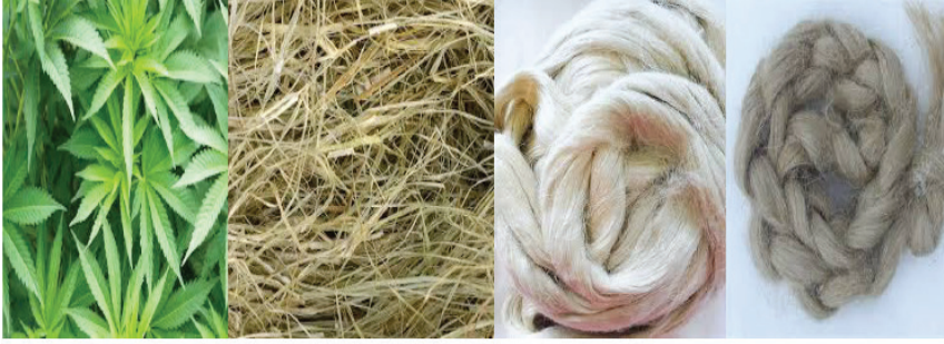
Şekil 2. Kenevir lifinin dönüşüm aşamaları [21]
