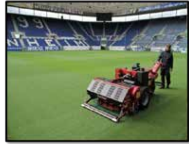
Şekil 2.2. Hibrit sistemli futbol sahalarda kullanılan havalandırma ekipmanları (URL-1; URL-2)
