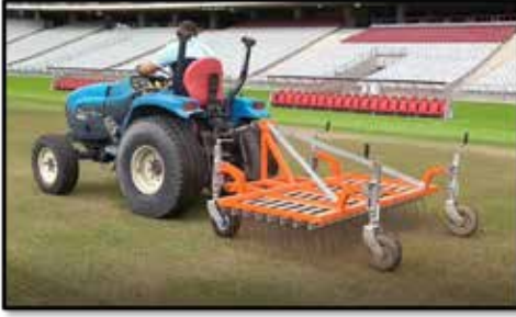
Şekil 2.6. Hibrit sistemli futbol sahalarında kullanılan tırmık ekipmanı
