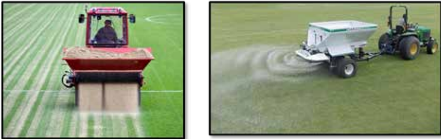
Şekil 2.4. Hibrit sistemli futbol sahalarında kullanılan kumlama ekipmanları (URL-3; URL-4)
