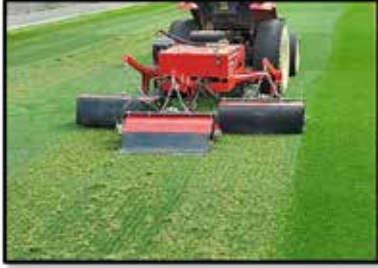
Şekil 2.7. Hibrit sistemli futbol sahalarında kullanılan verti-cut ekipmanı
