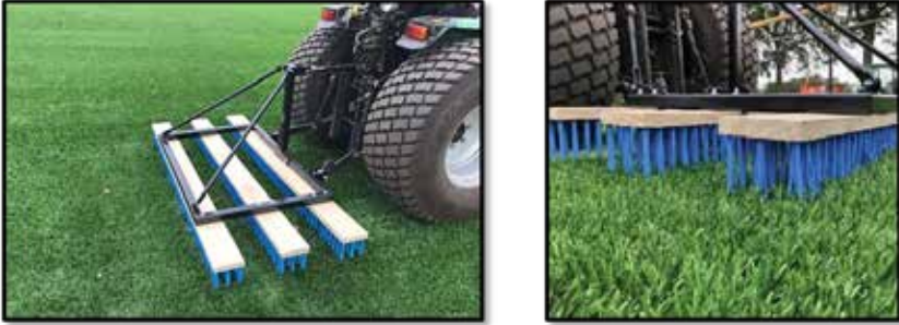
Şekil 2.5. Hibrit sistemli futbol sahalarında kullanılan fırçalama ekipmanları (URL-5)
