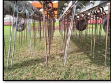
Şekil 2.6. Hibrit sistemli futbol sahalarında kullanılan tırmık ekipmanı
