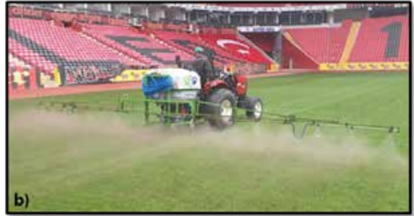
Şekil 2.11. Hibrit sistemli futbol sahalarında kullanılan gübreleme ekipmanları a) Gübre serpmek için kullanılan ekipman (URL-11) b) Pülverizatör
