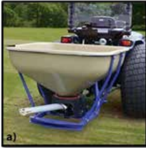
Şekil 2.11. Hibrit sistemli futbol sahalarında kullanılan gübreleme ekipmanları a) Gübre serpmek için kullanılan ekipman (URL-11) b) Pülverizatör
