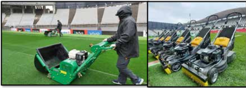
Şekil 2.1. Hibrit sistemli futbol sahalarında kullanılan silindirik ve döner bıçaklı çim biçme ekipmanları
