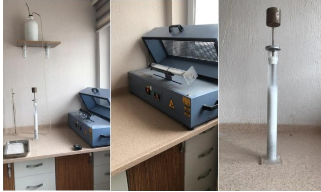
Şekil 2. Kum eşdeğeri deney adımları
