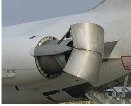
Şekil 2. Uçak itme ters çevirici sistemi
