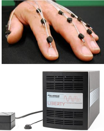
Şekil 5 Manyetik alana dayalı hareket yakalama sisteminde mikrosensörler ve elektronik kontrol birimi ("Polhemus," 2019)
