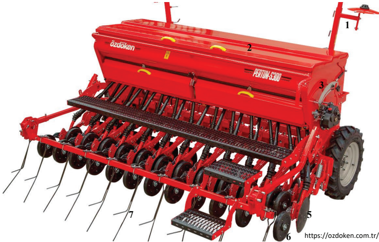
Şekil 1. Kesiksiz sıraya kombine ekim makinası; markör (1), tohum ve gübre sandıkları (2), hareket iletim düzeni (3), tohum boruları (4), ekici (gömücü) ayak (5), baskı tekeri (6), kapatıcı (7).
